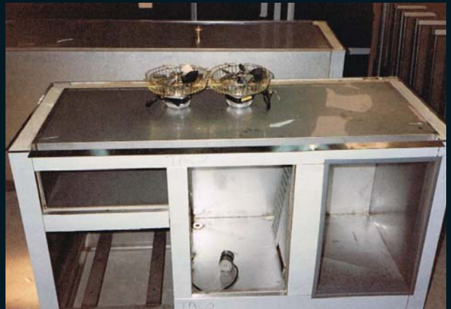
Primeiro protótipo de uma bancada com sistema de refrigeração ventilado
