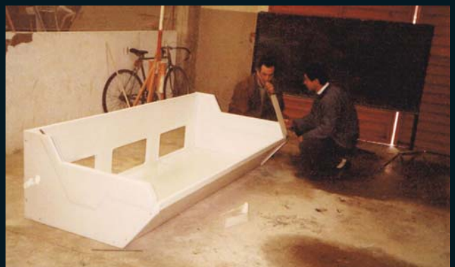
Molde em madeira para produzir uma vitrina em fibra de vidro
